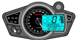
In der Standard-Ansicht können Sie durch Drücken der Auswahltaste verschiedene Funktionen anzeigen lassen. Bestimmte Kombinationen werden in folgender Reihenfolge angezeigt: Uhr + Tankanzeige > Digitalthermometer (Wasser) + Tankanzeige > Digitalthermometer (Öl) +
