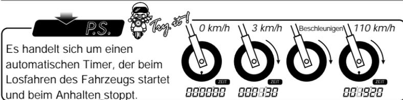
Es handelt sich um einen automatischen Timer, der beim Losfahren des Fahrzeugs startet und beim Anhalten stoppt.
