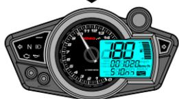
Wenn Sie die Höchstgeschwindigkeit erreichen (180 km/h), stoppt der Timer automatisch Entfernung (510 m) und Zeit (10 20 Sekunden).
