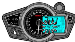
Drücken Sie die Auswahltaste, um zur Einstellung der Kolbenanzahl zu gelangen.
