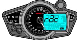
In der Einstell-Ansicht können Sie durch 3-sekündiges Gedrückt-Halten der Auswahlstaste zurück in die Standard-Ansicht wechseln.
