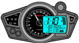
Wenn Sie die eingestellte Zielgeschwindigkeit erreichen (0-110 km/h), stoppt der Timer automatisch (19,20 Sekunden).
