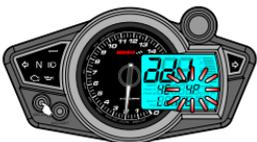
Drücken Sie die Auswahltaste, um zur Einstellung des Drehzahlseingangssignals zu gelangen.
