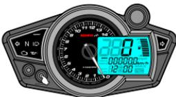
In der Standard-Ansicht können Sie durch Drücken der Einstelltaste verschiedene Funktionen anzeigen lassen. Die Funktionen werden in folgender Reihenfolge angezeigt: Gesamtkilometerstand > Tageskilometerstand A > Tageskilometerstand B > MAX-Speicher
