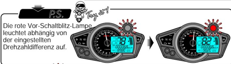
Die rote Vor-Schaltblitz-Lampe leuchtet abhängig von der eingestellten Drehzahldifferenz auf.
